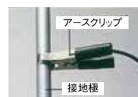
導電処理を施したホース (ホース長10m、20m、30mの3種類) の先端には、静電気を大地に逃せるように、アース線が取り付けられています。
