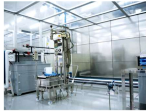
充填機からは発塵もあるため、汚れてもすぐに清浄度が回復するという点も高く評価
