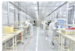
スーパークリーンルーム内部（ISOクラス1）で、貼り合わせ加工を実施
