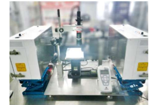
KOACHのユニットが捕集素材のシリカエアロゲルの清浄度を維持する
